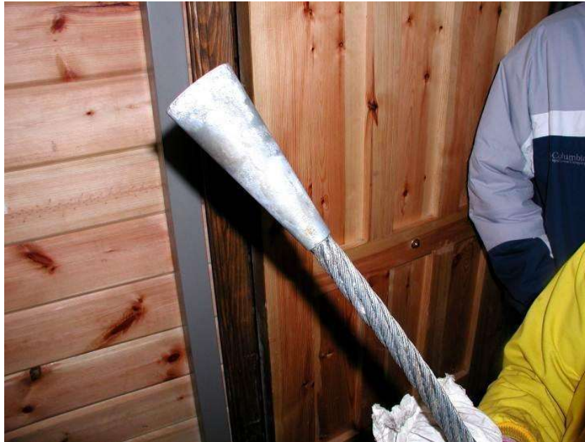
Ejemplo de terminal fundido en extremidad de cable tractor
