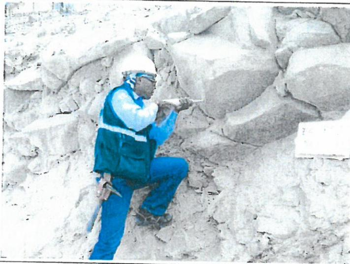
FOTO 26: Ensayo con martillo de Smith estación geomecánica EG-5
