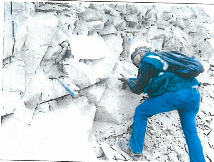
FOTO 28: Ensayo con martillo de Smith estación geomecánica EG-1
