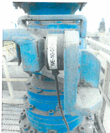
SENSOR E INDICADOR DE TORQUE WE/WIT -10-001F
